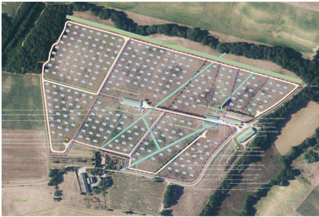
Le projet s'implante sur un terrain d'une exploitation de canards labellisée IGP canard à foie gras. Les panneaux photovoltaïques, surélevés à une hauteur comprise entre 1,8 et 4 mètres permettront d'apporter plusieurs bénéfices aux canards :
